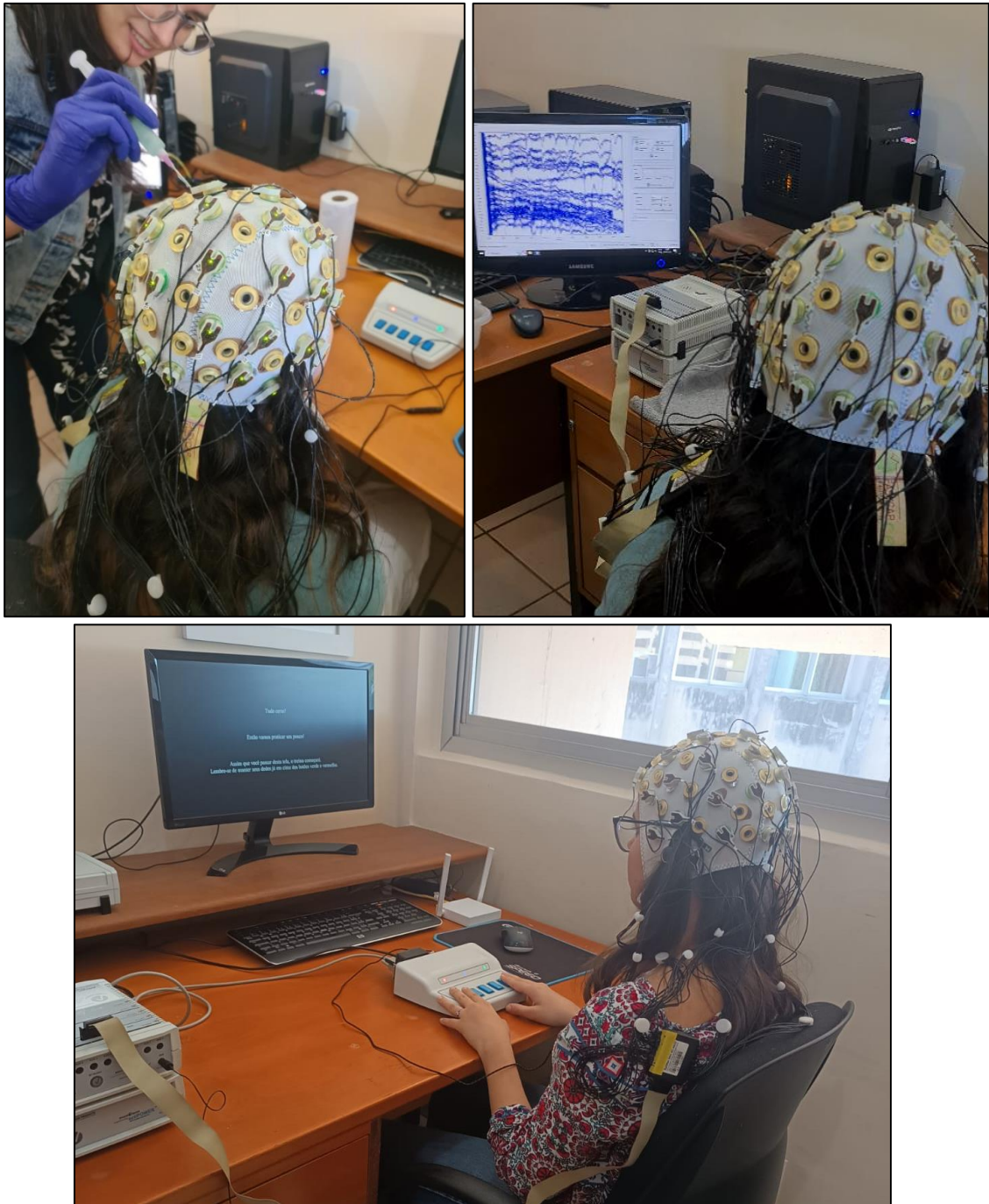
Figura 9. No canto superior esquerdo, a pesquisadora está inserindo gel condutor de eletricidade entre o eletrodo e o escalpo do participante. No canto superior direito, vê-se o participante com a touca e o conjunto de eletrodos conectados, de um lado, no escalpo do participante e, de outro, no amplificador. Na tela do computador, vê-se ondas elétricas captadas do escapo do participante e amplificadas. No canto inferior, vê-se uma participante lendo a tela de instruções do experimento, pronta para inicia-lo. Suas mãos e dedos já estão posicionados nos botões do dispositivo Chronos que usará para registrar suas respostas.
